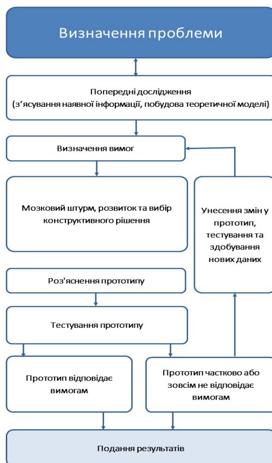
Рис. 10. Етапи науково-технічного та технічного дослідження з використанням етапів інженерного дизайну
