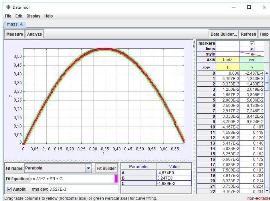
Рис. 7. Вигляд вікна Data Tool після накладання параболи
